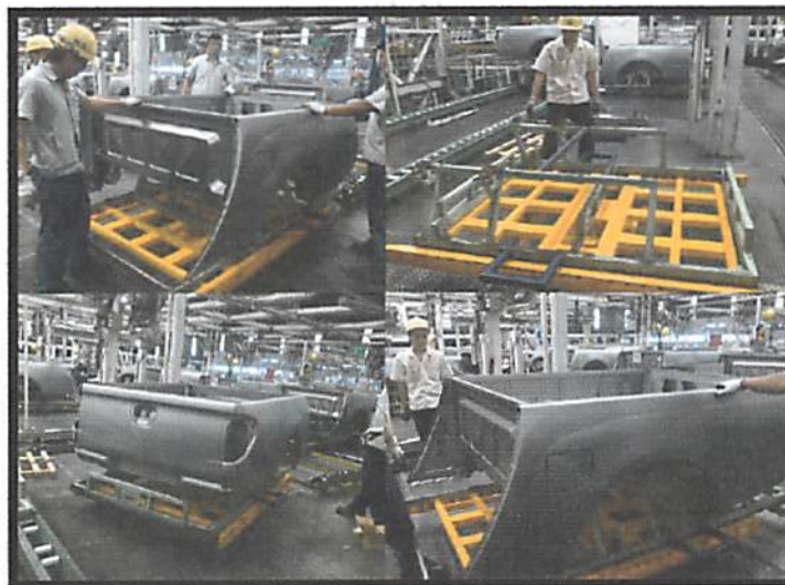
รูปที่ 8 แสดงการทดสอบการใช้งาน Stand Rotary
