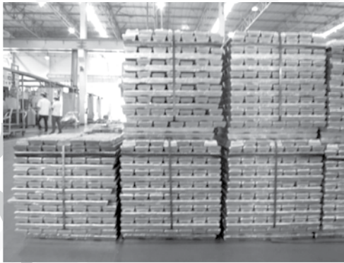
รูปที่ 3.2 แ่งอินกอท (Ingot) รอการหลอมเพื่อผลิตชิ้นงาน
