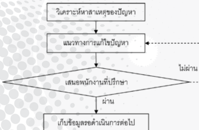
รูปที่ 3.12 แผนผังแสดงวิธีการวิเคราะห์หาสาเหตุของตำหนิ
